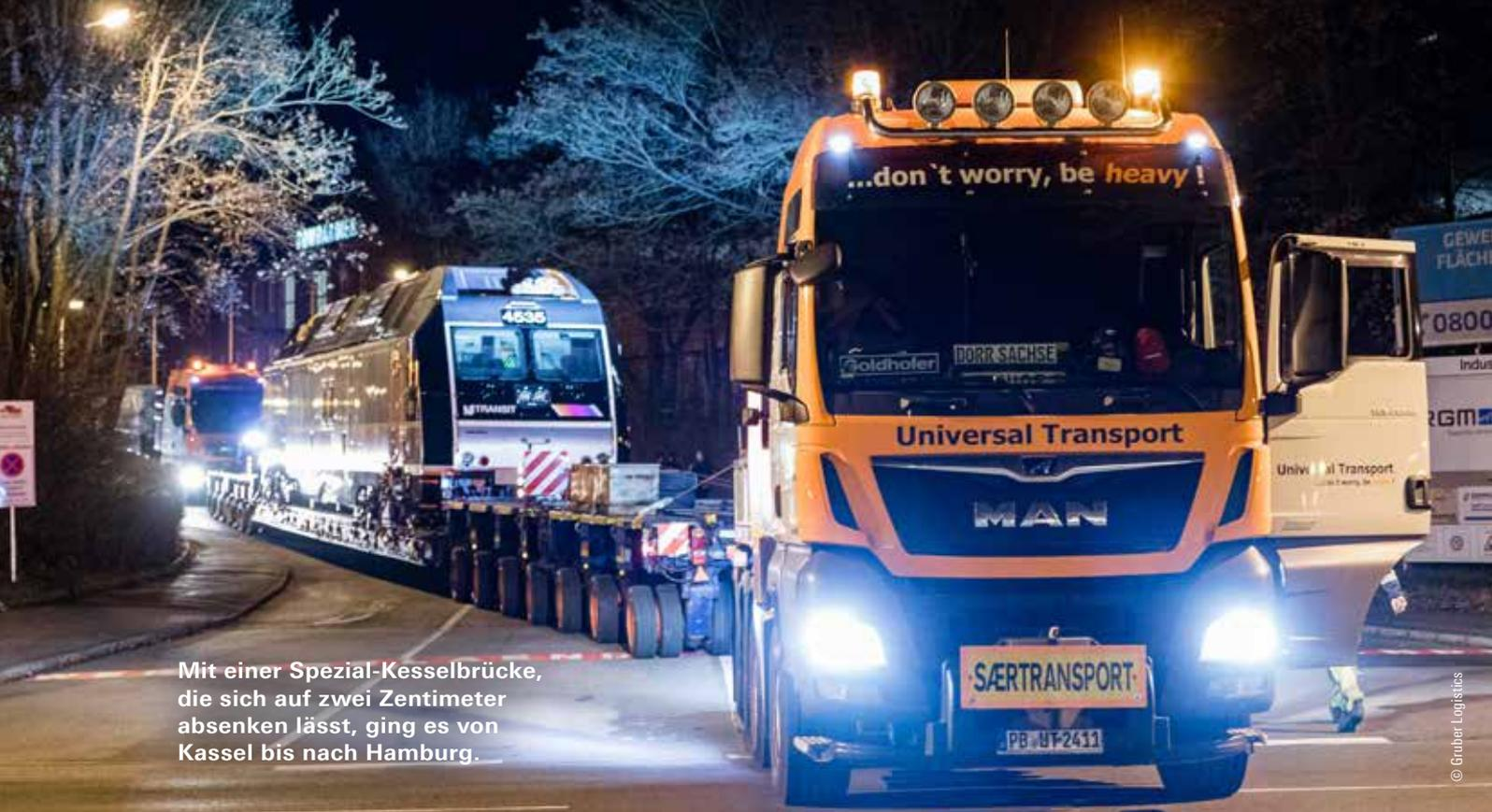
Mit einer Spezial-Kesselbrücke, die sich auf zwei Zentimeter absenken lässt, ging es von Kassel bis nach Hamburg.
